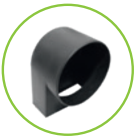
Geruchverschluss für Sinkkästen zum Nachrüsten DN 100/150 Einbau: Den Geruchverschluss innen im Sinkkasten einsetzen und mit dem Kanalrohr von aussen zusammenstecken.
