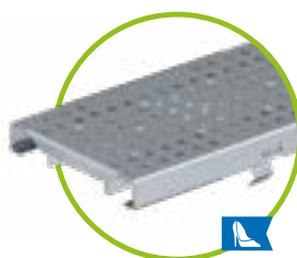
Lochrost verzinkt / Edelstahl, Ø 6,0 mm Kl. A und Kl. C für NW 100 Kl. C für NW 150, 200
