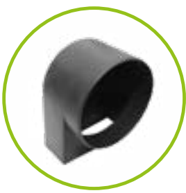
Geruchsverschluss für Sinkkasten zum Nachrüsten DN 100/150 Einbau: Den Geruchsverschluss innen im Sinkkasten einsetzen und mit dem Kanalrohr von aussen zusammenstecken.
