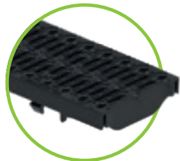
Kunststoff-Stegrost SW 8/40, Kl. C Kunststoff PA6 für NW 100
