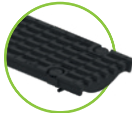
Guss-Längsstabrost MW 27/13, Kl. E für NW 100 - 200 SV oder 4-fach Verschraubung
