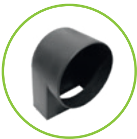
Geruchsverschluss für Sinkkästen zum Nachrüsten DN 100/150 Einbau: Den Geruchsverschluss innen im Sinkkasten einsetzen und mit dem Kanalrohr von außen zusammenstecken.
