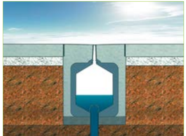
Der Regen hört auf, der kontrollierte Ablauf dauert an und der Wasserstand im BG-GATIC Slotdrain-System fällt ab.
