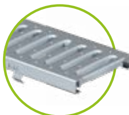
Stegrost SW 8/80, Kl. C verzinkt & Edelstahl für NW 100
