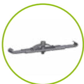
Rostverankerung zur Vandalismus- und Diebstahlsicherung für alle Abdeckungen mit fix-Verschluss der NW 100/150/200, mit Ausnahme von Stegrosten und COMBee-Designrosten (tec / pro). Bedarf je Abdeckung: 2 Stück
