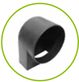
Geruchsverschluss für Sinkkästen zum Nachrüsten DN 100/150 Einbau: Den Geruchsverschluss innen im Sinkkasten einsetzen und mit dem Kanalrohr von außen zusammenstecken.
