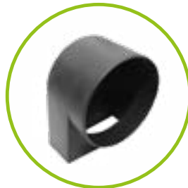
Geruchverschluss für Sinkkasten zum Nachrüsten DN 100/150 Einbau: Den Geruchverschluss innen im Sinkkasten einsetzen und mit dem Kanalrohr von außen zusammenstecken.
